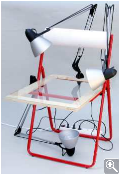
afb 1 | een klapstoel omgebouwd naar een opname-tafel met behulp van een paar latten, plaatje acryl, rol behang en drie bureaulampen.
