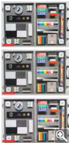
afb 2 | 'testcase' EF 28mm 1.8 en 2.8 en EF 35mm 1.4L bij één stop kleiner dan maximaal diafragma. (EOS 1000D en ISO 100)
