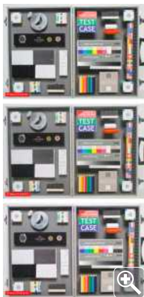
afb 2 | 'testcase' EF 28mm 1.8 en 2.8 en EF 35mm 1.4L bij één stop kleiner dan maximaal diafragma. (EOS 1000D en ISO 100)
