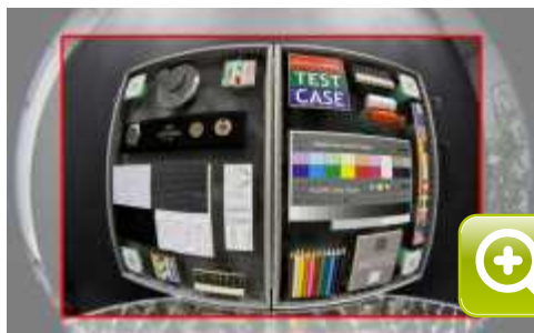
afb 3 | uitsnede van sensor uit beeldcirkel 15mm fisheye
